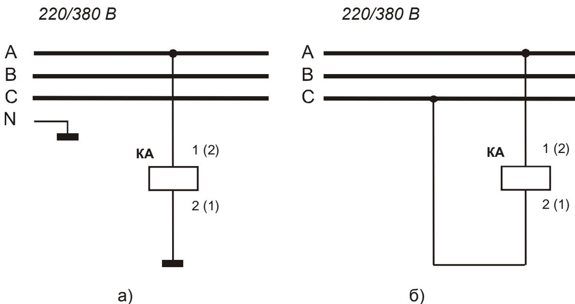
Рисунок 3 - схема питания реле от оперативного напряжения 220 В (а) или 380 В (б)
