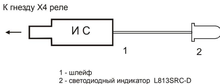
Рисунок 8 - внешний вид индикатора сигнального ИС
