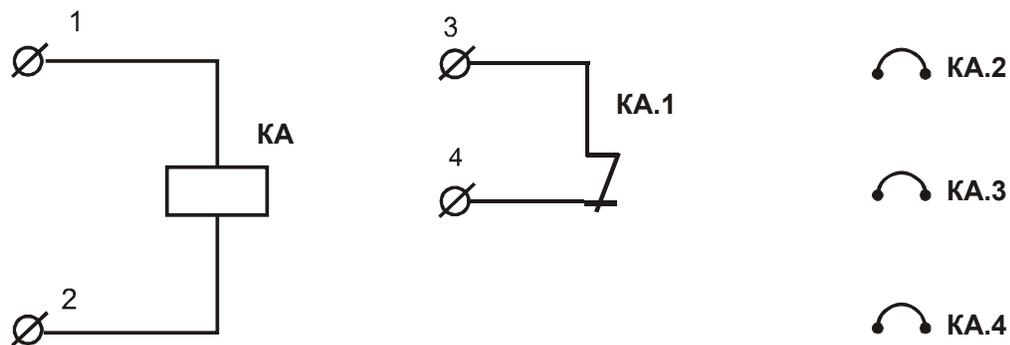
Рисунок 2 - условное графическое обозначение реле
