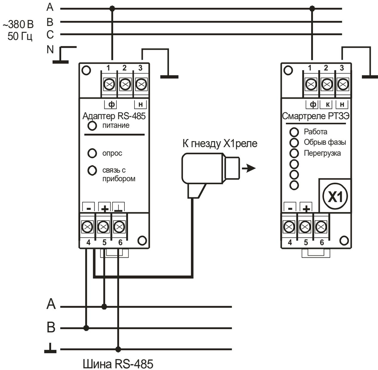
Рисунок 2 – схема подключения адаптера RS-485
