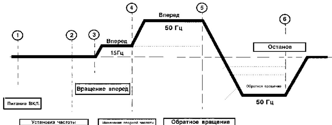
Рис. 15. Последовательность операций при работе с пульта управления.
