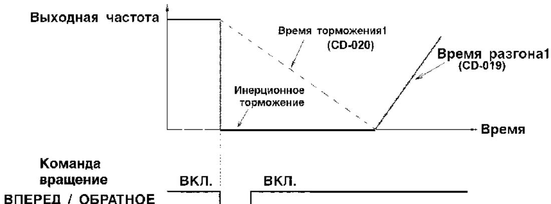
После того, как подана команда на останов, пока электродвигатель тормозится, управление невозможно. Команда ВРАЩЕНИЕ проходит, но до останова электродвигателя управление не может быть начато. Однако, если время торможения меньше минимального, установленного с помощью константы CD-053, управление преобразователем невозможно в течение времени, установленного CD-053.
