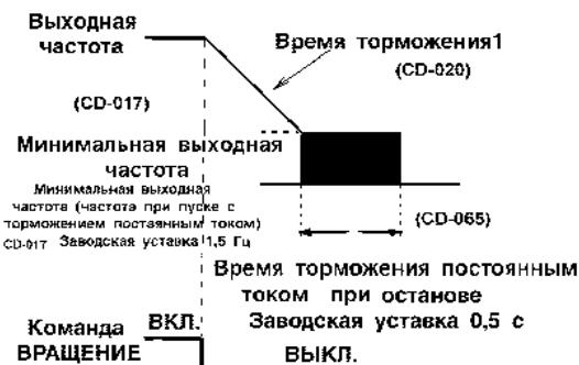
С момента отключения команды на **вращение ВПЕРЕД (ОБРАТНОЕ вращение)** электродвигатель тормозится со скоростью торможения, определяемой уставкой времени торможения 1 (CD-020), и торможение постоянным током прикладывается непосредственно перед остановом. Если время торможения мало или инерция нагрузки велика, при торможении может наблюдаться неисправность в виде перегрузки по напряжению.
