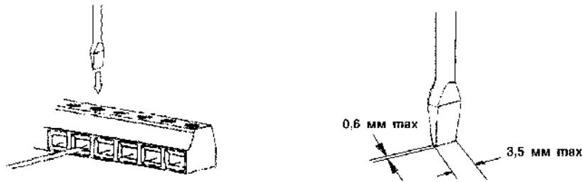
Ведите провод в нижнюю часть клеммной колодки и надежно закрепите в соответствующей ячейке колодки с помощью отвертки. Освобожденный от оболочки участок провода должен иметь длину 7 мм.
