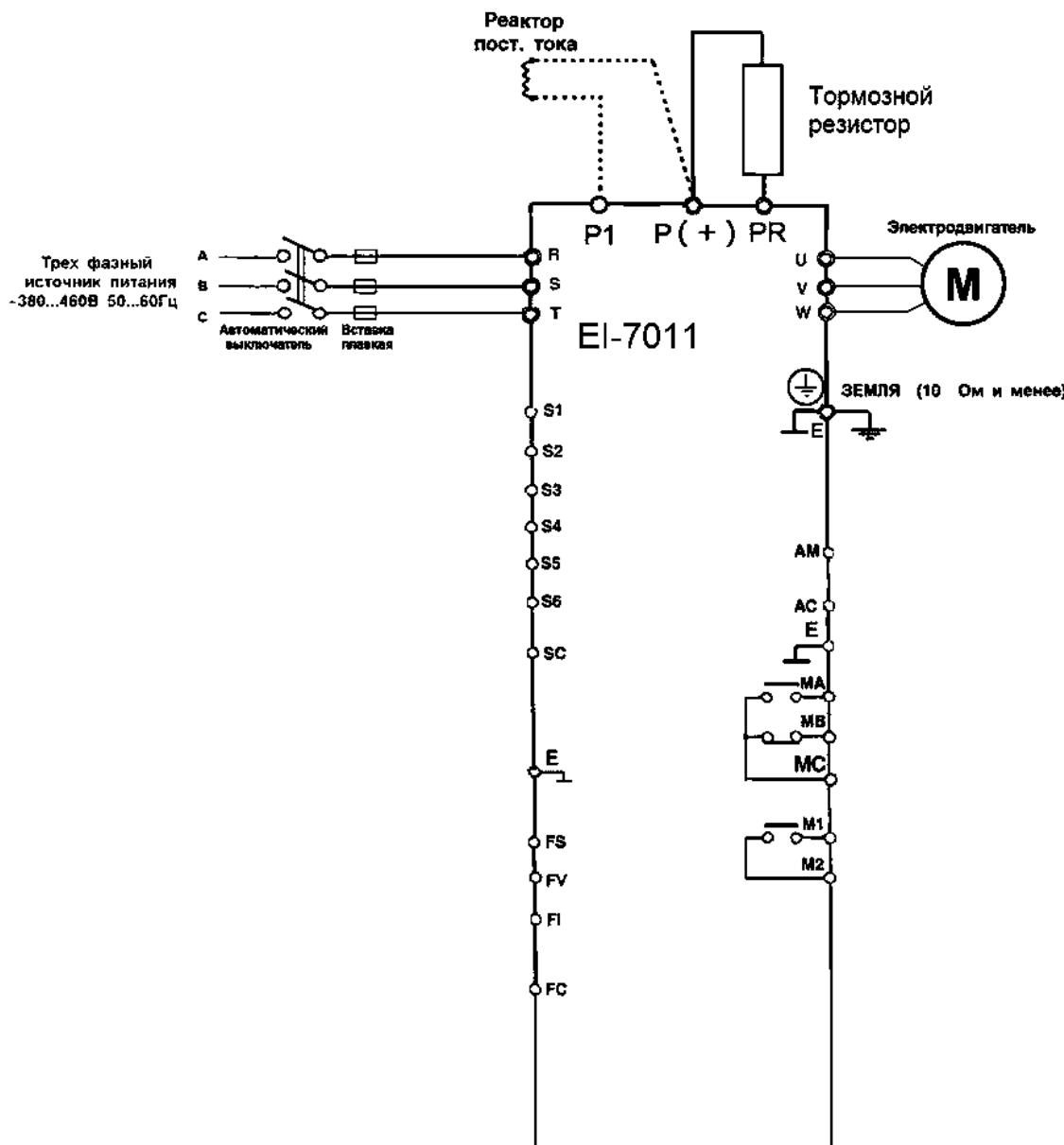
1. При установке реактора постоянного тока удалите перемычку между клеммами Р (+) и Р1 и подсоедините реактор к этим клеммам (модель 020Н).
