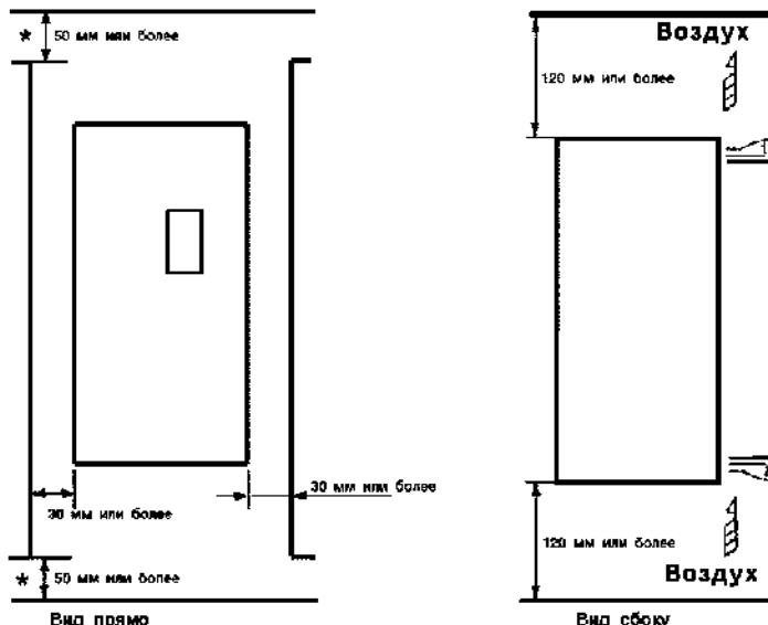
Рис. 8 Минимально допустимые расстояния до окружающих устройств.
