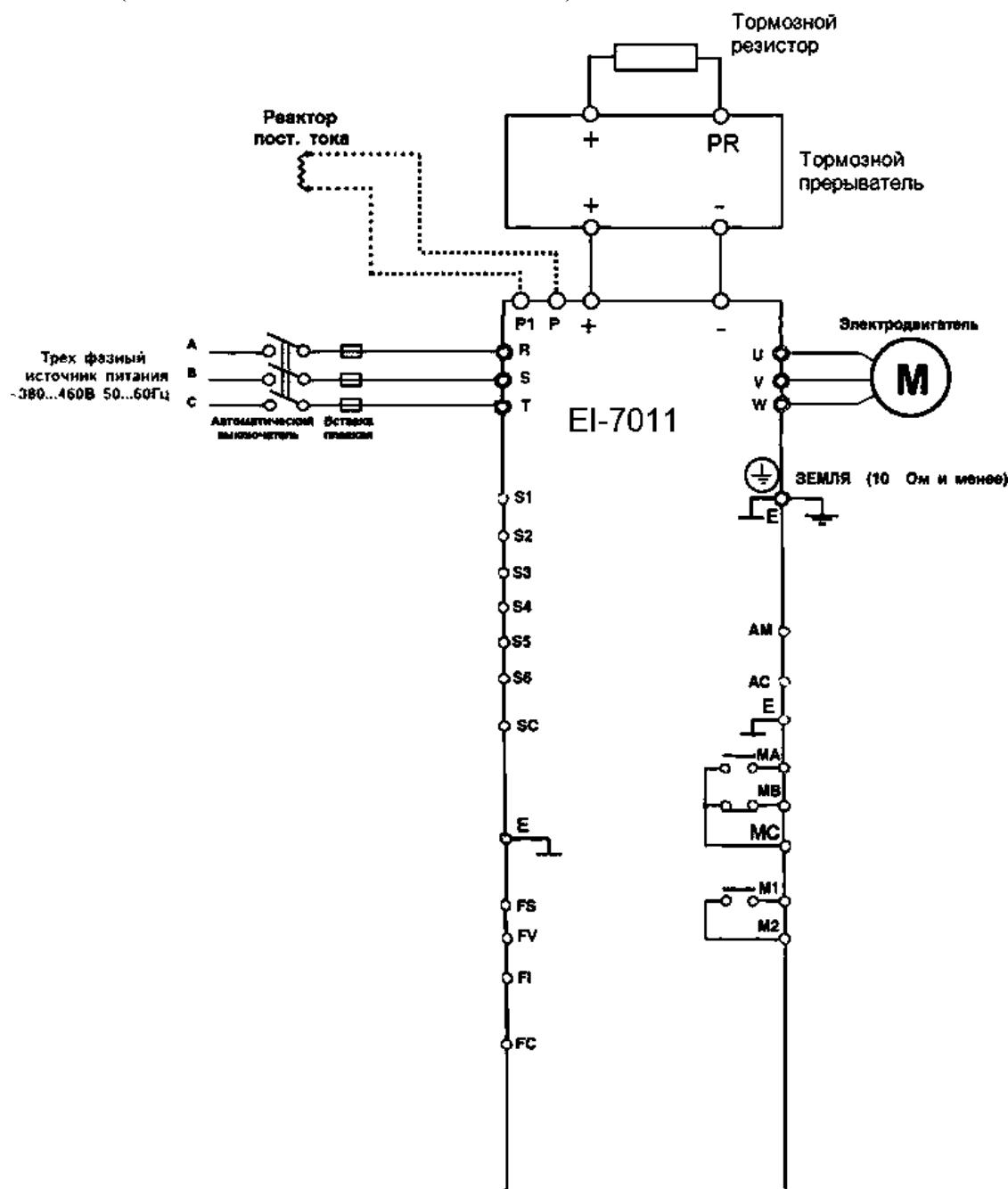
1. При установке реактора постоянного тока удалите перемычку между клеммами Р и Р1 и подсоедините реактор к этим клеммам (модели 025Н...050Н).
