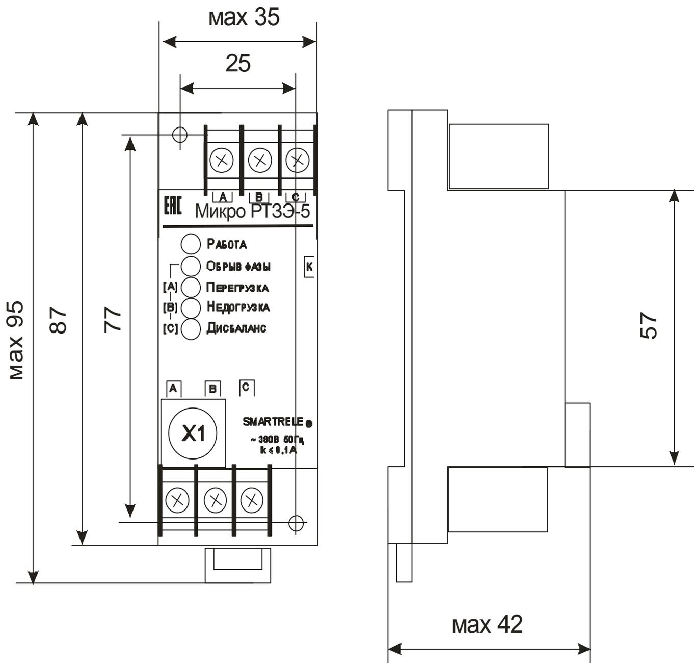
Рисунок 2 – габаритные и установочные размеры Микро РТЗЭ-5
