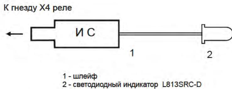
Рисунок 6 - внешний вид индикатора сигнального ИС
