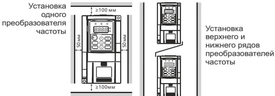
Рисунок 3.1. Схема установки
