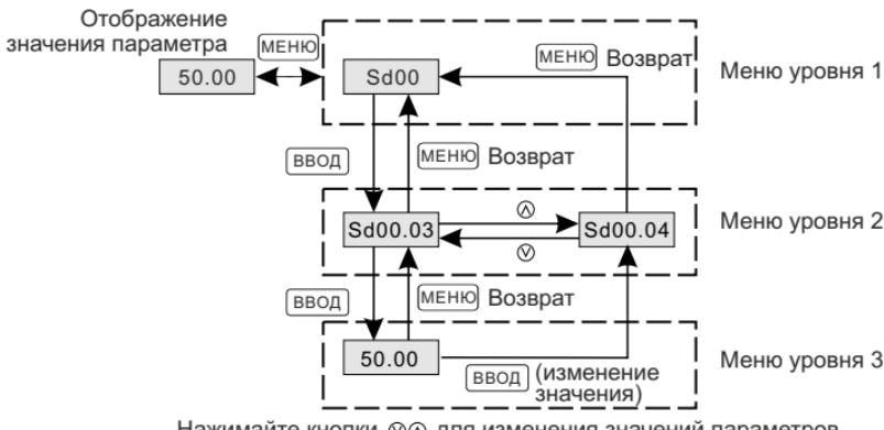
Рисунок 4.2. Порядок работы с панелью управления
