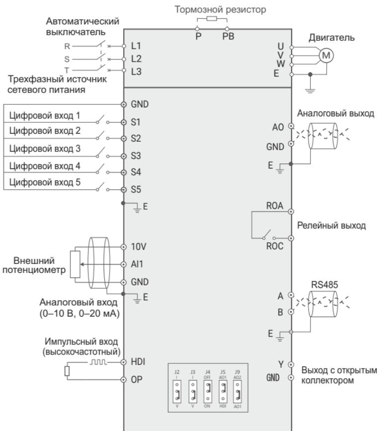
Рисунок 3.3. Схема основных электрических соединений (1)
