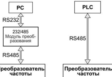
Рисунок 7.1. Режим «Одно ведущее устройство и одно ведомое устройство»
