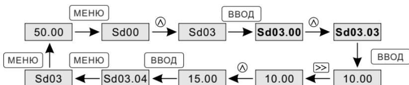
Рисунок 4.3. Пример изменения значения параметра
