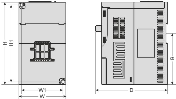
Рисунок 2.4. Габариты и монтажные размеры
