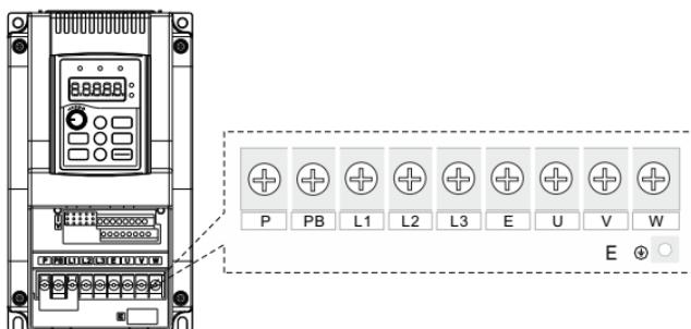
Рисунок 3 5. Схема цепей электропитания преобразователя частоты SDI
