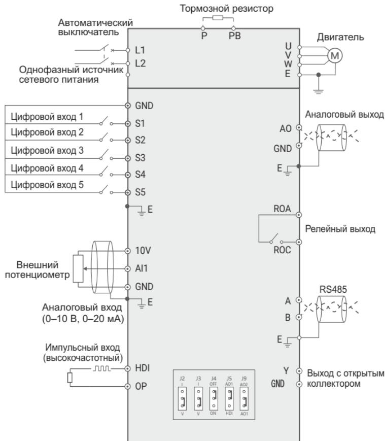
Рисунок 3.4. Схема основных электрических соединений (2)
