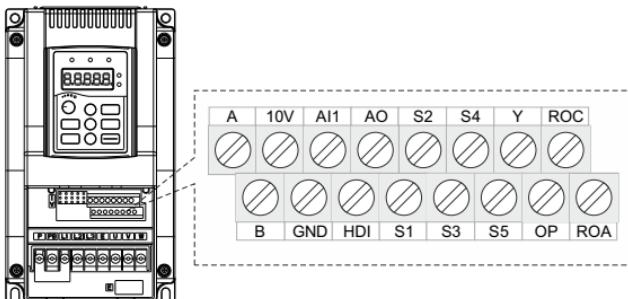
Рисунок 3.6. Схема расположения клемм цепей
