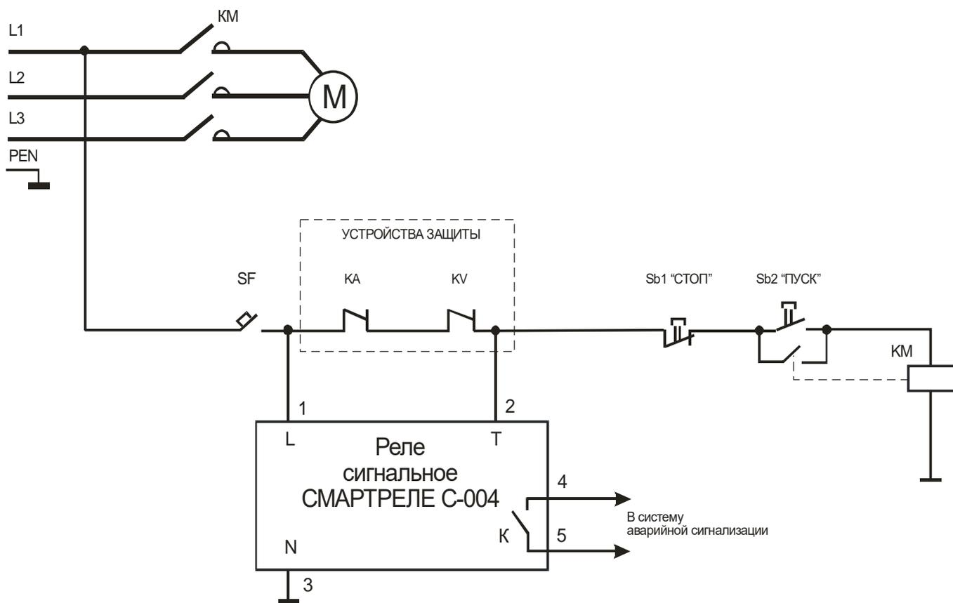
Рисунок 2 – схема включения реле в систему релейной защиты и управления
