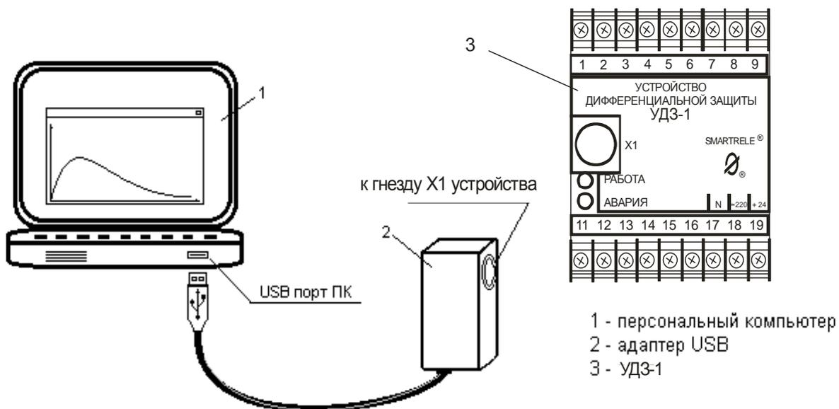
Рисунок 3 – подключение устройства к ПК с помощью адаптера USB
