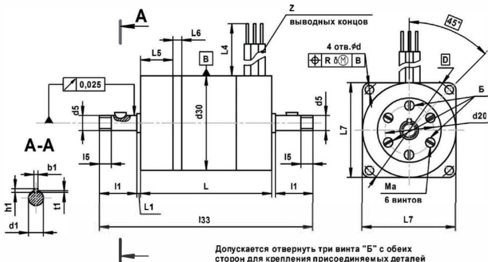
Допускается отвернуть три винта "Б" с обеих сторон для крепления присоединяемых деталей
